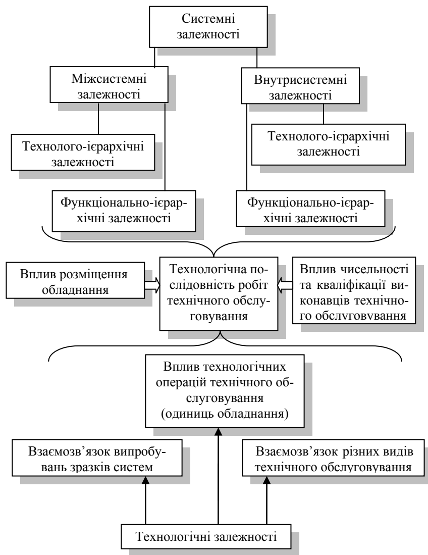
РИС. 1. Схема залежностей, що впливають на технологічну послідовність виконання робіт технічного обслуговування
