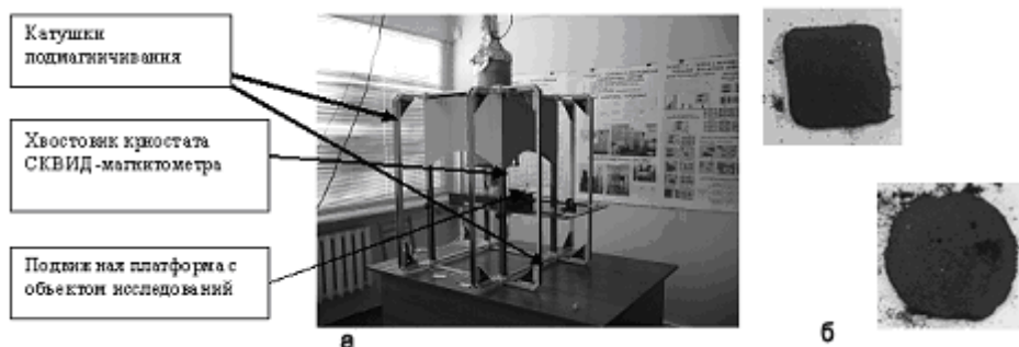
РИС. 1. а – магнитометрическая система для регистрации и исследования магнитных сигналов, б – образцы угольного вещества
